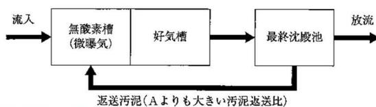
図 4-5 循環式硝化脱窒法として取り扱うことのできるものの事例
